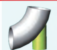
エルボー管接合枝切断
